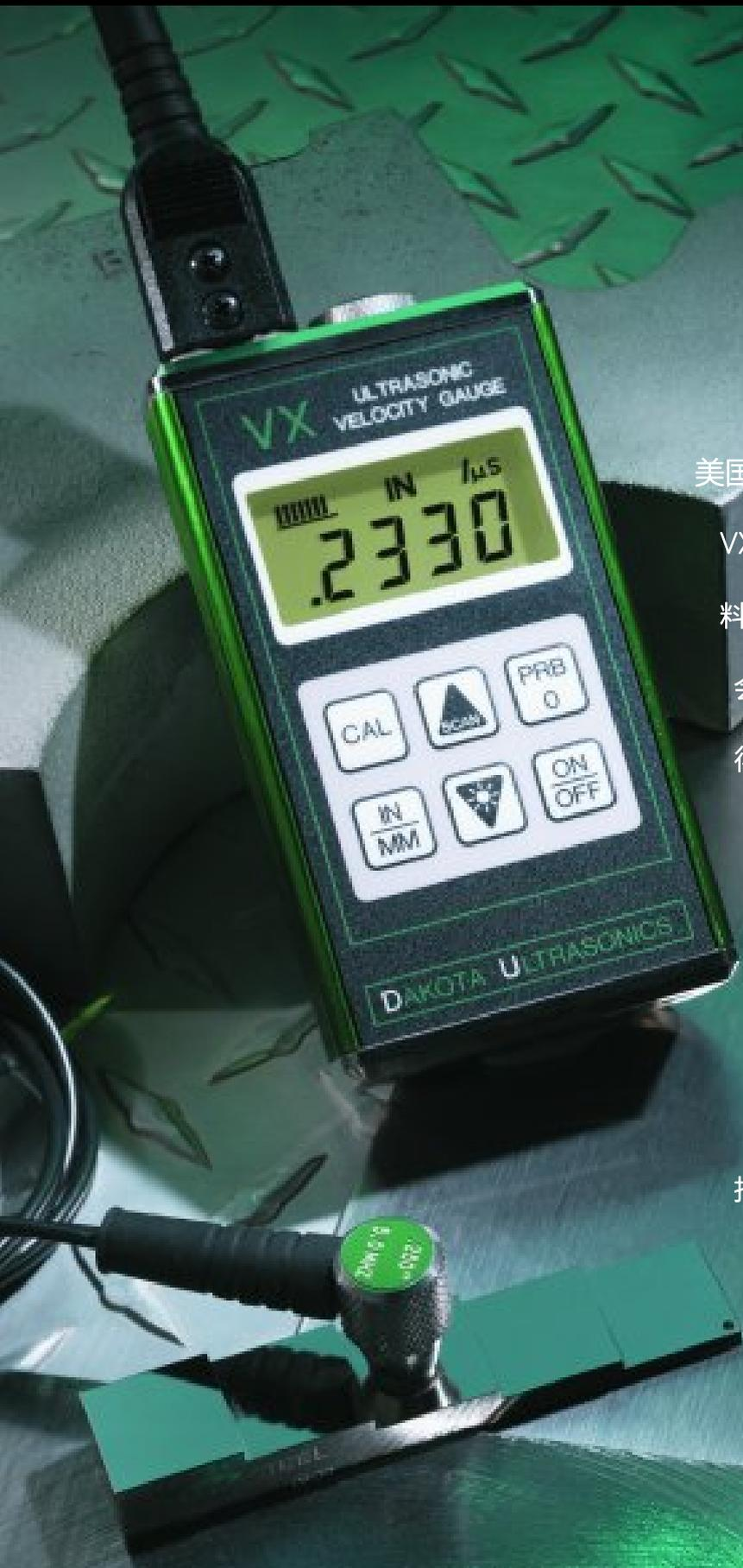
美国达科特 DAKOTA ULTRASONICS 公司 VX 是手持式超声波声速测定仪。当测量材料，比如是铸件、合金或者塑料时，VX 就会测出声波穿过它们时的速度。因此，可得出所测材料内部组织是否紧密无缺陷。
