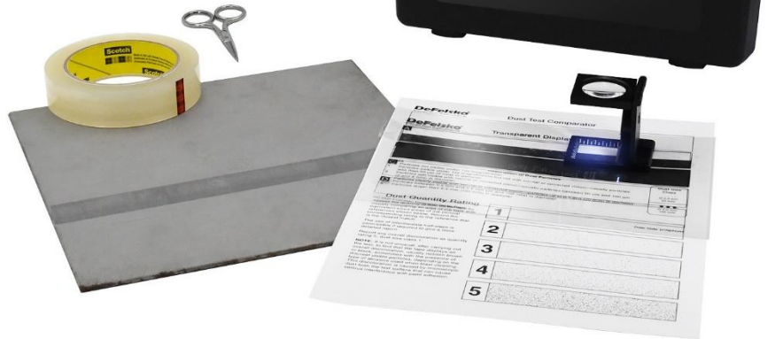
便捷灰尘测试比较卡，包括用于确定灰尘大小和灰尘量等级的图表参考
