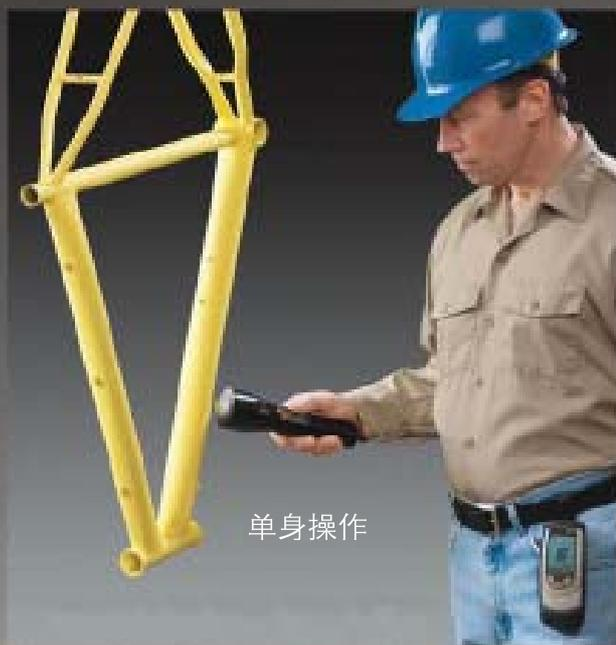
美国 DeFelsko 公司 Positector PC 采用非接触超声波原理，可在涂装工件未固化时测量粉末厚度，所测读数为固化后的干膜厚度
