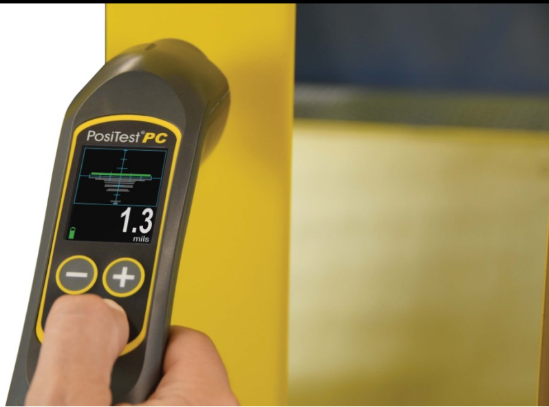
目标栅格同时显示到工件的距离和对准情况，使测量变得容易
