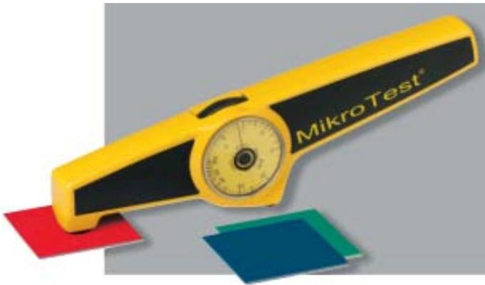
MikroTest 涂镀层测厚仪，测量钢铁上所有非磁性涂镀层厚度（如油漆、粉末涂层、塑料、橡胶、锌、铜、锡和镍等）。测量快速、精确、无损。三十多年来 MikroTest 已成为被广泛应用的自动测定涂镀层厚度的专用仪器。德国的“诀窍”说明它在工艺技术及测量精度方面，具有磁性覆层测厚仪的最高水准。所有仪器均符合 DIN、ISO、BS 及 ASTM 标准。
