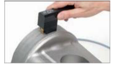
在确定裂纹的角度后，对斜裂纹深度的测量
