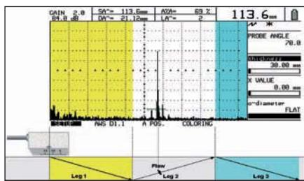
新的“彩条”指针可以不同颜色显示横波探伤检测的各条数据。
