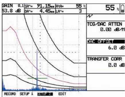
多曲线DAC以红色显示记录的DAC曲线，其余4条附加曲线基于dB平衡功能，辅助添加的缺陷定量。TCG衰减和转换修正功能，使其可应用在多种其他材料和表面条件下。
